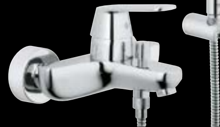
32 831 000 vanová • 3 509 Kč automatické přepínání: vana/sprcha, zajištěno proti zpětnému toku 32 832 000 vanová včetně sprchové soupravy • 4 408 Kč ruční sprcha (27 367 000), sprchová hadice relaxaflex 1 500 mm (28 151 000), nástěnný držák (27 056 000)
