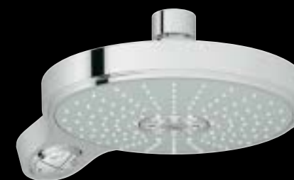
27 764 000 Power&Soul • 3 886 Kč průměr: 190 mm, s přepínacím tlačítkem, sprchové proudy: Rain, Rain 02, Bokoma Spray™, Jet, kulový kloub s otočným úhlem ±30° 27 765 000 Power&Soul • 3 886 Kč s omezovačem konstantního průtoku 9,5 l/min.
