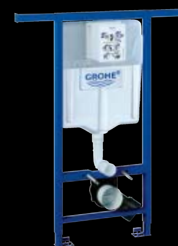
38 588 001 Rapid SL – pro závěsné WC • 10 034 Kč pro obložení sádkartone, pro instalační šachty, šířka 800–1 000 mm, stavební výška 1,13 m
