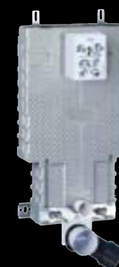
38 643 001 Uniset – pro závěsné WC • 5 481 Kč splachovací nádržka pro obezdění, dvoučinné splachování nebo START/STOP, odhlučňový EPS-modul 830×470×130 mm
