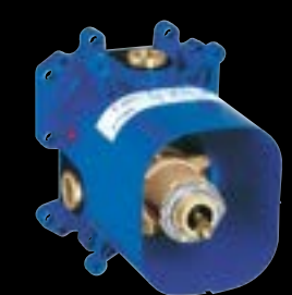
35 501 000 podomítkové těleso Rapido E • 3 219 Kč keramická kartuše 46 mm s technologií SilkMove®, variabilně nastavitelný omezovač průtoku, možná plochá vestavba 70–100 mm
