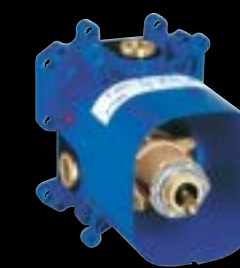
35 501 000 podomítkové těleso Rapido E • 3 219 Kč keramická kartuše 46 mm s technologií SilkMove®, variabilně nastavitelný omezovač průtoku, možná plochá vestavba 70–100 mm
