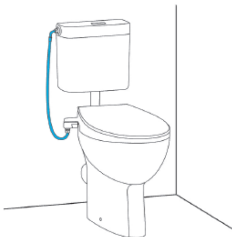
ZAPOJENÍ K VENTILU UVNITŘ SPLACHOVACÍ NÁDRŽE
