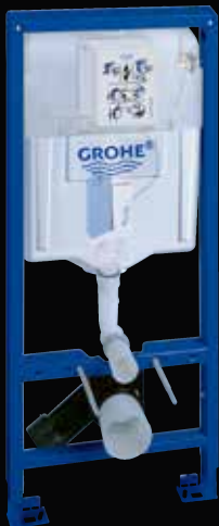
38 528 001 Rapid SL – pro závěsné WC • 6 237 Kč pro obložení sádrokartonem, stavební výška 1,13 m, dvoučinné splachování nebo START/STOP
