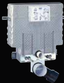
38 415 001 Uniset – pro závěsné WC • 7 749 Kč splachovací nádržka pro obezdění, stavební výška 82 cm, ovládání zepředu nebo shora, dvoučinné splachování nebo START/STOP
