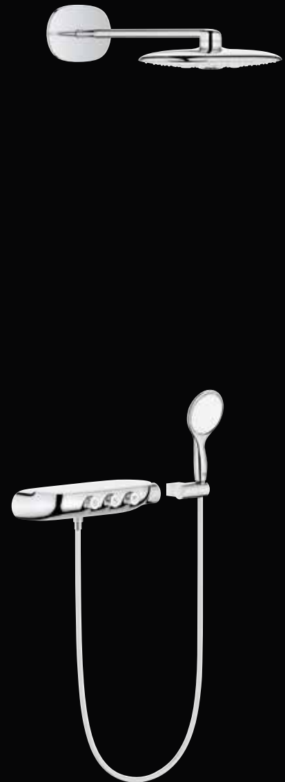
26 443 000 SmartControl 360 DUO • 41 040 Kč set obsahuje: nástěnný/podomítkový termostat s přepínačem, ruční sprchu (27 671 1S0), nástěnný držák ruční sprchy (27 055 000), hlavovou sprchu Rainshower 360 DUO s horizontálním 450mm sprchovým ramenem, sprchovou hadici 1 500 mm (28 364 000), vyžaduje vestavbový set (26 264 001) a podomítkové těleso (26 449 000) – musí být objednány samostatně
