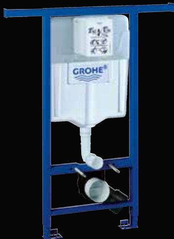
38 588 001 Rapid SL – pro závěsné WC • 9 963 Kč pro obložení sádrokartonem, pro instalační šachty, šířka 800–1 000 mm, stavební výška 1,13 m
