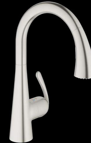
32 294 001 ZEDRA, chrom · 10 991 Kč 32 294 SD1 ZEDRA, supersteel · 15 776 Kč integrovaná, vytahovací sprška, otočná výtoková trubice, přepínač: perlátor/sprcha
