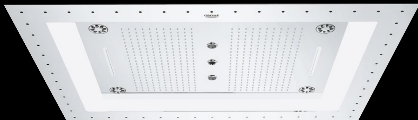
26 373 000 Rainshower F-Series 40" AquaSymphony • 573 707 Kč rozměr: 1 016×762×155 mm (kovová), stropní sprcha 6+ proudů s osvětlením, minimální průtok 25 l/min 1 × AquaCurtain 1 × Pure XL proud 1 × 2 studená mlha – proud 2 × GROHE PureRain proud 400 x 190 mm 1 × 2 XL vodopád 1 × 4 Bokoma Spray s úhlem seřízení 20° a kombinací plnospektrální LED: měkké světlo s měnícími se barvami duhy samostatně nastavitelné: trvalé osvětlení s výběrem barvy
