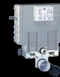
38 415 001 Uniset – pro závěsné WC • 7 830 Kč splachovací nádržka pro obezdění, stavební výška 82 cm, ovládání zepředu nebo shora, dvoučinné splachování nebo START/STOP
