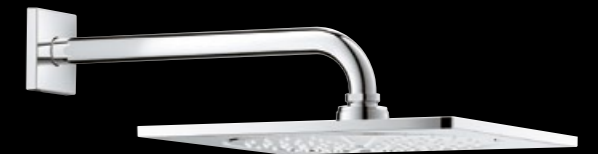
26 060 000 Rainshower F • 12 412 Kč rozměr: 254×254 mm (kovová), sprchový proud Rain, kulový kloub s otočným úhlem ±20°, včetně sprchového ramena 275 mm (27488000)
